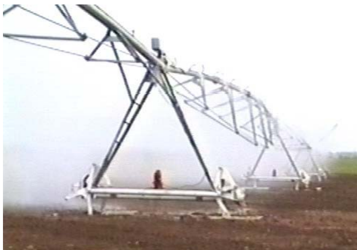
Рис. 2. Дождевальная машина «Кубань» с шагающими движителями.
